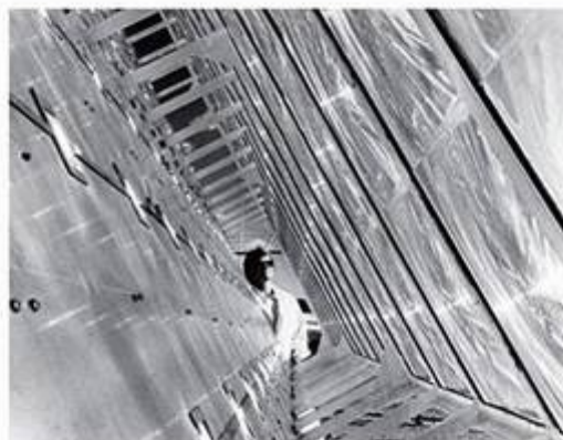
Usando 135 lentes de fresnel poliméricas (à direita) montadas diretamente em frente ao número correspondente de células solares de silício (pontos brilhantes à esquerda), o conjunto concentrador fotovoltaico no Sandia Labs do U.S. Department of Energy produz um quilowatt de eletricidade. Cada lente de fresnel focaliza o equivalente a 50 sóis em uma célula solar correspondente para converter a luz do sol diretamente em energia. (Cortesia do Laboratório Nacional de Sandia)
