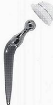
Figura 20.13 Uma haste e uma esfera de cromo-cobalto, com uma taça de polietileno, formam um sistema de esfera e taça acetabular para uma junta de quadril artificial. (Cortesia da DePuy, uma Divisão de Boehringer Mannheim Corporation.)
