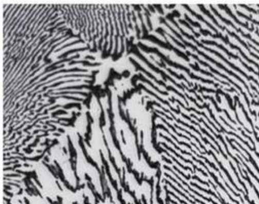
A microestrutura de uma solda macia 'eutética' resfriada lentamente ( \approx 38\% p Pb– 62\% p Sn) consiste de uma estrutura lamelar de solução sólida rica em estanho (branca) e solução sólida rica em chumbo (escura), 375X. (De ASM Handbook, vol. 3: Alloy Phase Diagrams, Ohio: ASM International, 1992.)
