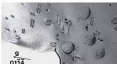
Figura 19.26 Micrografia eletrônica dos ciclos de discordância produzidos no Al_2O_3 como resultado da irradiação por feixe de elétrons. (Cortesia de D. G. Howitt.)
