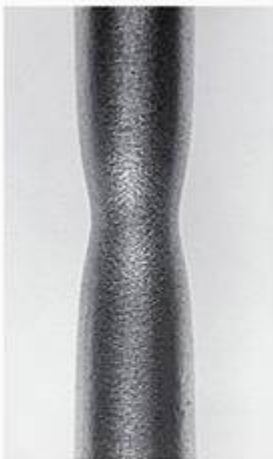
Figura 6.7 Pescoço de um corpo-de-prova em um ensaio de tração dentro de seu comprimento útil após a extensão além do limite de resistência à tração. (Cortesia de R. S. Wortman.)
