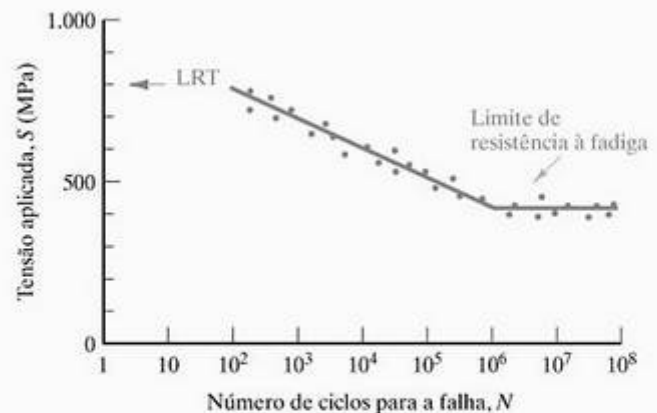
Figura 8.10 Curva de fadiga típica. (Observe que é preciso usar uma escala logarítmica para o eixo horizontal.)
