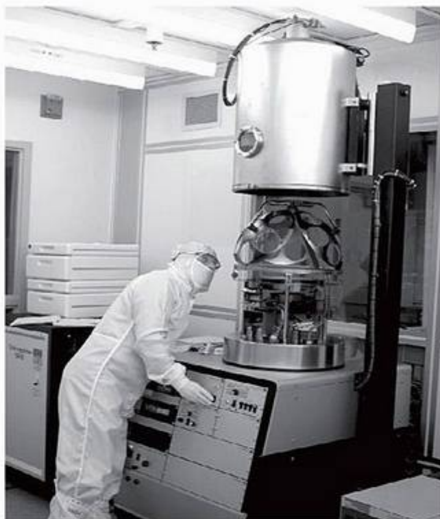
Alguns dos processos de manufatura mais sofisticados de hoje foram desenvolvidos para a produção de dispositivos eletrônicos em estado sólido. Um exemplo é a evaporadora por feixe de elétrons que pode fornecer revestimentos de alta qualidade em pastilhas de semicondutores. (Cortesia da University of California, Davis.)
