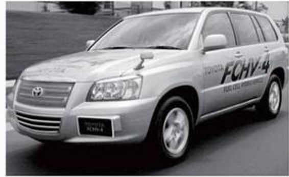
Protótipo do veículo utilitário esportivo da Toyota alimentado por célula combustível sob avaliação na Universidade da Califórnia, em Davis. (Cortesia da Universidade da Califórnia, Davis.)
