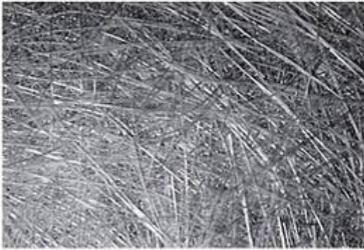
Figura 14.1 Fibras de vidro a serem usadas como reforço em um compósito de fibra de vidro. (Cortesia da Owens-Corning Fiberglas Corporation.)
