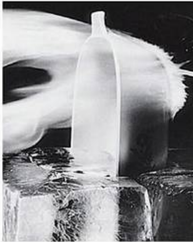
Figura 1.10 Material de cozinha fabricado de uma cerâmica vítrea, que oferece boas propriedades mecânicas e térmicas. O prato de cassarola pode suportar um choque térmico de temperaturas simultaneamente altas (uma chama de fogo) e baixa (um bloco de gelo). (Cortesia da Corning Glass Works.)
