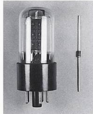
Figura 17.18 Comparação de uma válvula retificadora à vácuo com um correspondente em estado sólido. Esses componentes permitiram a miniaturização substancial nos primórdios da tecnologia de estado sólido. (Cortesia da R. S. Wortman.)
