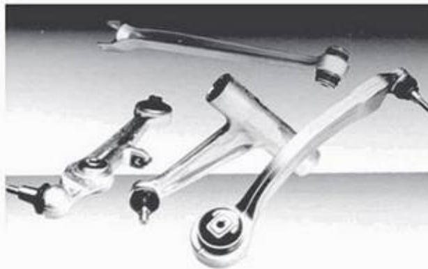
Os componentes da direção e suspensão de automóveis são feitos de alumínio forjado por oferecer menos peso e mais economia de combustível. (Cortesia da TRW.)
