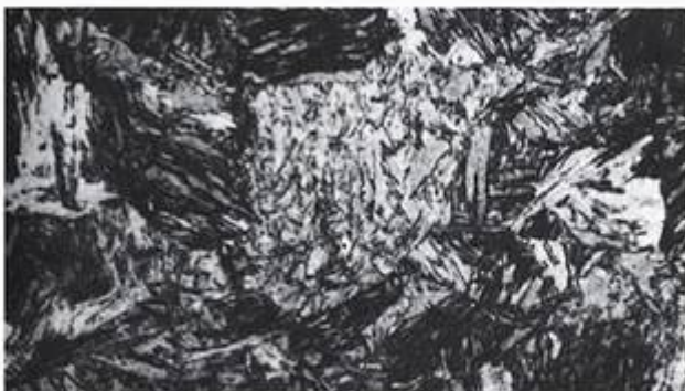
Figura 10.13 A microestrutura acicular (ou em forma de agulha) da martensita 1000x. (De Metals Handbook , 8. ed., Atlas of Microstructures , Ohio: American Society for Metals, vol. 7, 1972.)
