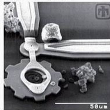
Unidade MEMS de redução de velocidade com múltiplas marchas. (Cortesia da Sandia National Laboratories, SUMMIT™ Technologies, www.mems.sandia.gov )
