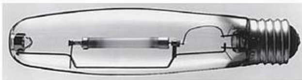
Figura 1.21 Lâmpada de vapor de sódio em alta temperatura, que se tornou possível pelo uso de um cilindro de \text{Al}_2\text{O}_3 translúcido para conter o vapor de sódio. (Observe que o cilindro de \text{Al}_2\text{O}_3 está dentro do envelope de vidro exterior.) (Cortesia da General Electric Company.)
