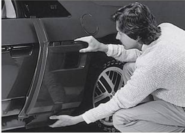
Figura 1.13 O painel traseiro nesse carro esportivo foi uma aplicação pioneira de um polímero de engenharia em uma aplicação metálica estrutural tradicional. O polímero é um náilon moldado por injeção. (Cortesia da Du Pont Company, Engineering Polymers Division.)
