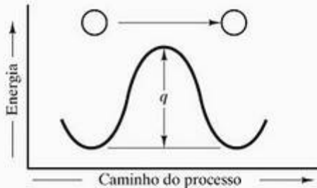
Figura 5.2 Caminho de um processo mostrando como um átomo deve superar uma energia de ativação, q , para passar de uma posição estável para uma posição adjacente semelhante.
