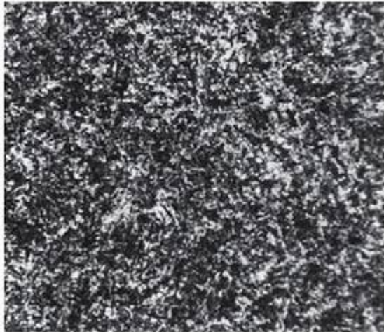
Figura 10.9 A microestrutura da bainita envolve agulhas extremamente finas de \text{Fe } \alpha e \text{Fe}_3\text{C} , em contraste com a estrutura lamelar da perlita (veja a Figura 9.2), 535x. (De Metals Handbook , 8. ed; Atlas of Microstructures , Ohio: American Society for Metals, vol. 7, 1972.)
