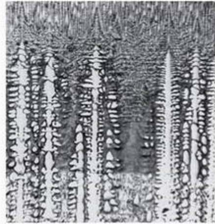
Figura 11.6 Exemplo de uma estrutura dendrítica tipo árvore em uma liga 20 Pb-80 Sn. Uma microestrutura eutética é vista na base dos dendritos. (De Metals Handbook , 9. ed., Casting, Ohio: ASM International, vol. 15, 1988.)
