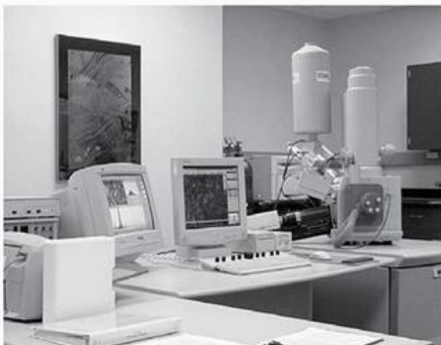
Os microscópios eletrônicos de varredura são ferramentas especialmente úteis para caracterizar a natureza fundamental dos materiais. (Cortesia do Departamento de Engenharia Química e Ciência dos Materiais, Universidade da Califórnia, Davis).
