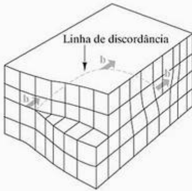
Figura 4.13 Discordância mista. Essa discordância tem características de aresta e espiral, com um único vetor de Burgers coerente com as regiões puramente de aresta e espiral.
