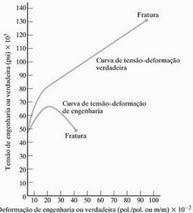
Figura 6.8 A tensão verdadeira (carga dividida pela área real na região do pescoço) continua a subir até o ponto de fratura, ao contrário do comportamento da tensão da engenharia. (De R. A. Flinn e P.K.Trojan, Engineering Materials and Their Applications , 2. ed., Houghton Mifflin Company, 1981, usado com permissão.)
