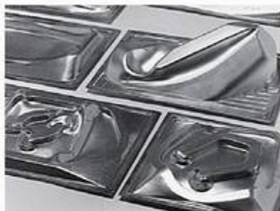
Figura 1.4 Diversas peças de alumínio fabricadas por deformação superplástica. O alto grau incomum de deformabilidade para essas ligas é possível com uma microestrutura minuciosa, cuidadosamente controlada. A formação superplástica utiliza a pressão do ar para esticar uma 'bolha' de folha de metal sobre um molde metálico. (Cortesia da Superform USA.)
