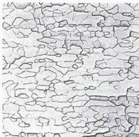
Figura 9.1 Microestrutura monofásica do molibdênio comercialmente puro, 200x. Embora haja muitos grãos nessa microestrutura, cada grão tem a mesma composição uniforme. (De Metals Handbook , 8. ed., Atlas of Microstructures , Ohio: American Society for Metals, vol. 7, 1972.)
