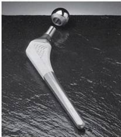
Figura 20.14 A haste de quadril Omnifit® HA consiste de um revestimento de hidroxiapatita sobre uma prótese de substituição de quadril com a finalidade de melhorar a adesão entre a prótese e o osso. A hidroxiapatita é a fase mineral predominante no osso natural. (Cortesia da Osteonics, Allendale, NJ.)
