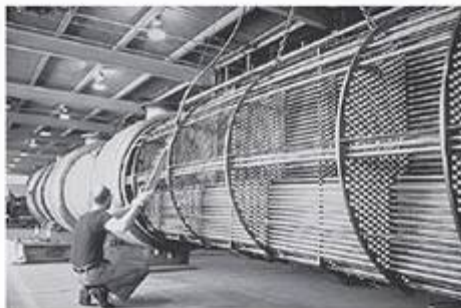
Este trocador de calor para a indústria de processamento químico contém mais de 17 quilômetros de tubos de zircônio. Zircônio é o material selecionado para muitas dessas aplicações, devido à sua alta resistência à corrosão em diversos ambientes químicos ácidos e básicos. (Cortesia da Teledyne Wah Chang, Albany, OR.)
