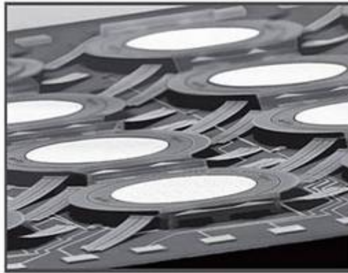
Uma chave óptica com pequenos espelhos direciona os fótons de luz (dados) para o destino apropriado. (Cortesia da Lucent Technologies/Bell Labs.)
