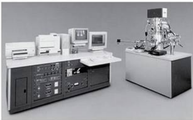
Figura 19.32 Uma microsonda comercial para realizar a varredura por espectroscopia de elétrons Auger. (Cortesia da Perkin-Elmer, Physical Electronics Division.)
