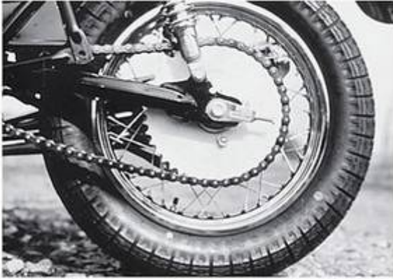
Figura 20.8 Uma coroa feita de náilon reforçado por dispersão substituiu peças de alumínio e aço em muitos projetos para corridas de motocross. (Cortesia de Du Pont Company, Engineering Polymers Division.)
