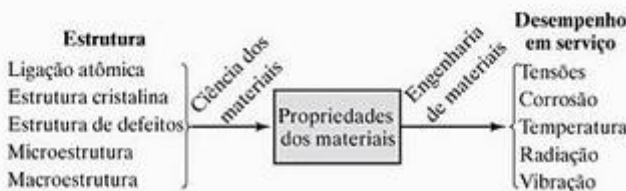
Figura 20.2 Esquema do papel central desempenhado pelas propriedades na seleção de materiais. As propriedades são um elo entre os aspectos fundamentais da ciência de materiais e os desafios práticos da engenharia de materiais. (De G. E. Dieter, ASM Handbook , vol. 20, Materials Selection and Design , Ohio: ASM International, 1997, p. 245.)
