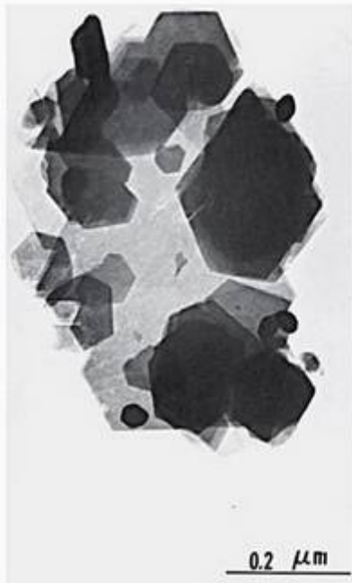
Figura 3.17 Micrografia eletrônica de transmissão da estrutura das plaquetas argilosas. Essa estrutura em escala microscópica é uma manifestação da estrutura cristalina em camadas mostrada na Figura 3.16. (Cortesia de I.A. Aksay.)
