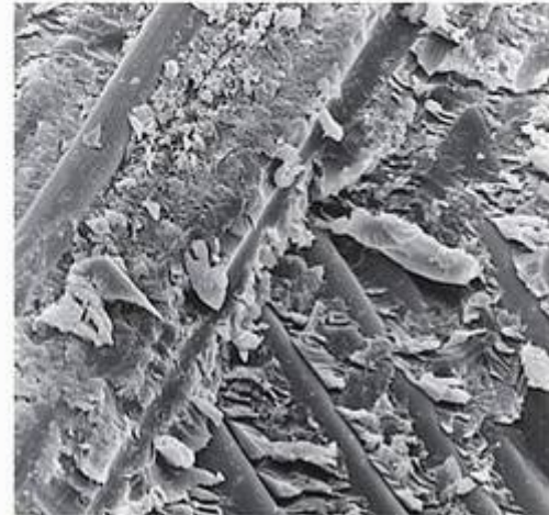
Figura 14.2 O reforço de fibra de vidro em um compósito de fibra de vidro é claramente visto em uma imagem de microscópio eletrônico de varredura de uma superfície de fratura. (Cortesia da Owens-Corning Fiberglas Corporation.)
