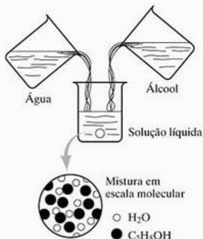
Figura 4.1 Formando uma solução líquida de água e álcool. A mistura ocorre em escala molecular.
